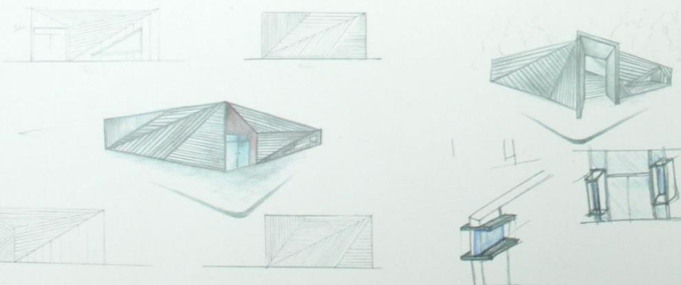
Il modulo progettato, di dimensioni 5mX4mX3m, è realizzato interamente in legno, sia per quanto riguarda la struttura che il rivestimento.
